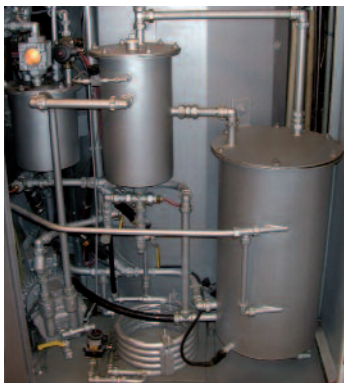
Verhindert Geruchsbildung: das Wasserabscheidesystem
