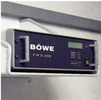
Das Per-Messsystem überwacht den Lösemittelrestgehalt
