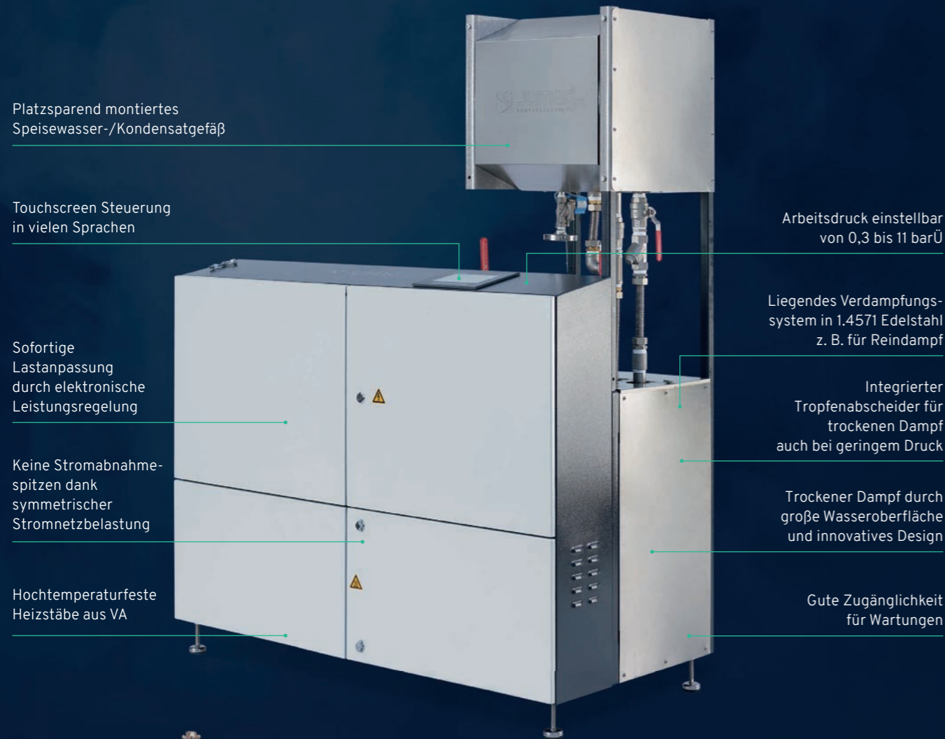
Abb.: JUMAG Elektro-Dampferzeuger EDI mit integriertem Speisewasser-/Kondensatgefäß
